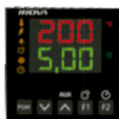
Controle digital independente por cuba no modelo FOG 3C DP.
